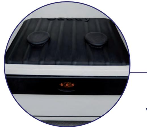
Doppel Handsensor Funktionsfreigabe. Beide Hände auf die Drehknöpfe gegenüber dem Sensor legen, um die Funktionen Verschiebung /Aufwärtsbewegung/ Abwärtsbewegung der Maschine freizugeben.
