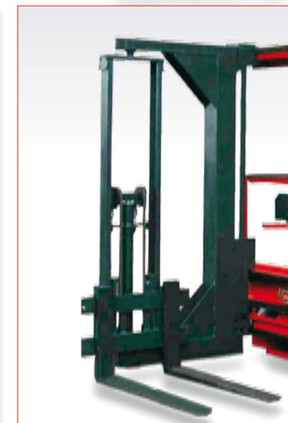
Die Mastschwenkgabel ist das häufigste und flexibelste Anbaugerät. Für sehr schwere Einsätze, z. B. große Tragbaumlänge, bieten wir eine besonders stabile Konstruktion an, die zusätzlich noch am Fahrerschutzdach geführt werden kann.
