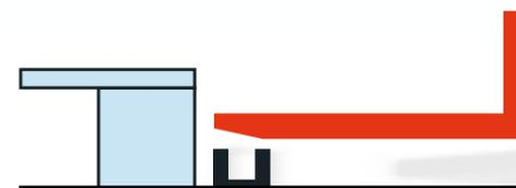
Ein induktiv geführtes Gerät benötigt keine Führungsschienen.
