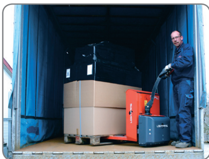
Panther Maxi AC (Tragkraft 1800 kg) wird für schweren Palettentransport, z.B. für Speditionen, empfohlen.
