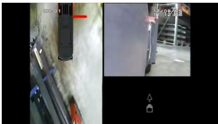
Der in die bewährte Universalschiene integrierte Splitscreen Monitor zeigt eine 270° Vogelperspektive und optional eine Vorwärtsperspektive auf Radarmhöhe. Die Vogelperspektive ermöglicht ein sicheres Rangieren im Umsetzgang, während die optionale Vorwärtsperspektive die Einfahrt in den Schmalgang unterstützt. Gerade bei mechanisch geführten Fahrzeugen ergibt sich hierdurch ein großes Plus an Betriebssicherheit.
